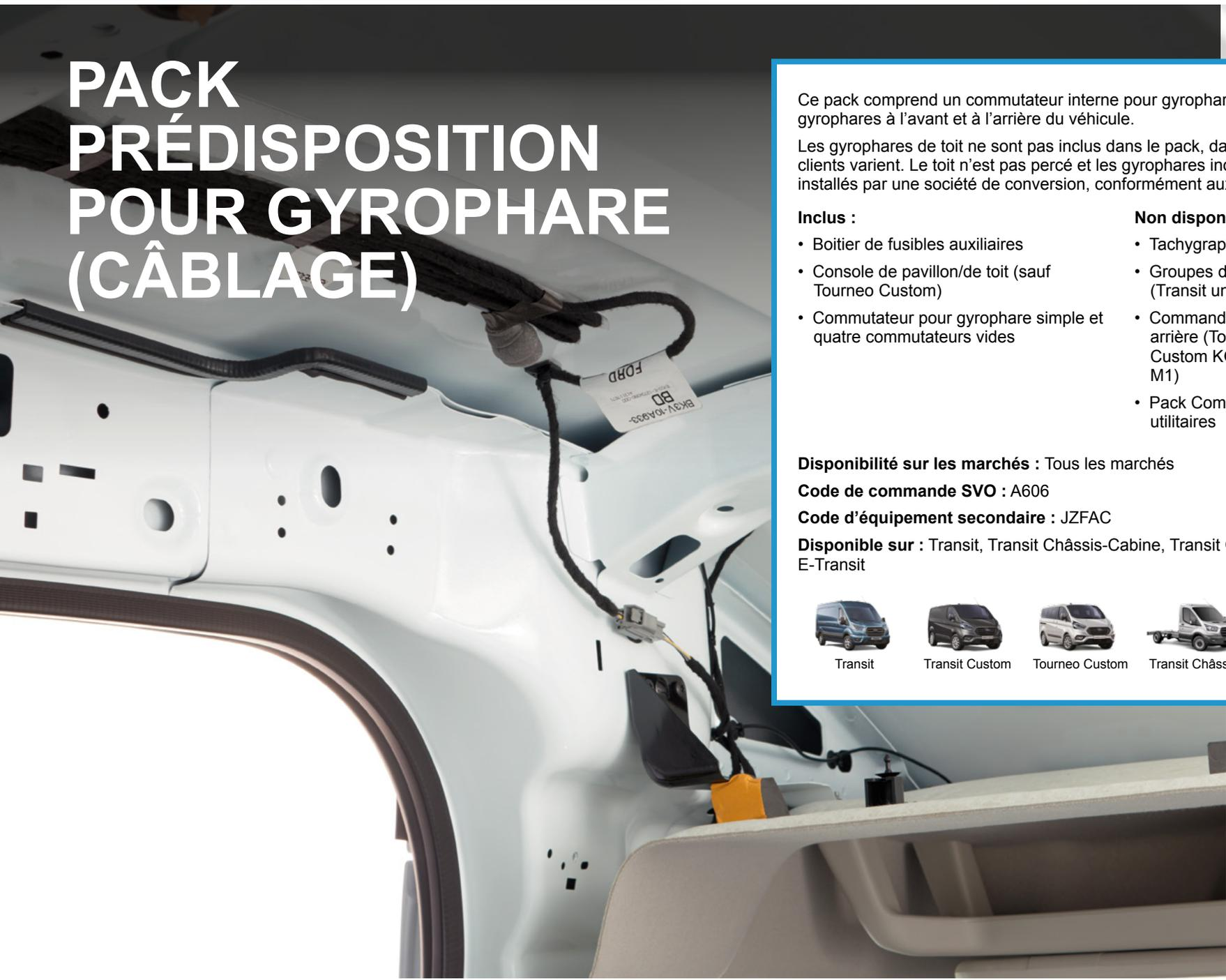
Ce pack comprend un commutateur interne pour gyrophare ainsi que du câblage pour gyrophares à l'avant et à l'arrière du véhicule.
