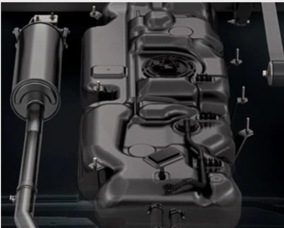
L'orifice à carburant auxiliaire comprend une conduite de carburant et un connecteur facilitant le raccordement des chauffages auxiliaires (Webasto, Eberspaecher, etc...). Il est doté d'un connecteur femelle TI LOCC QC 7.89 de série ; il est cependant recommandé d'acheter un adaptateur mâle 7.89 en complément (fabricant : TI Automotive GmbH).
