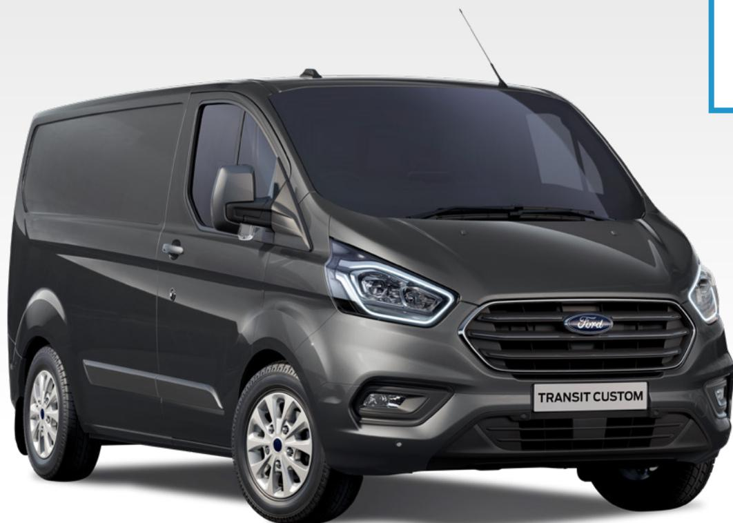
Le fourgon postal de Ford est un véhicule pour conversions avec une capacité de charge réduite, offrant un total de 2,8 tonnes sur la plaque VIN afin de rester conforme légalement dans certains pays qui autorisent que les véhicules montent sur le trottoir.
