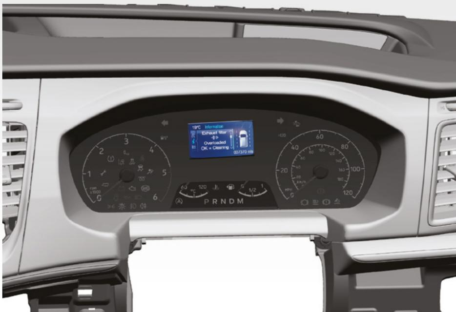
Le filtre à particules diesel (FAP) aide à supprimer les particules des gaz d'échappement d'un moteur diesel.
