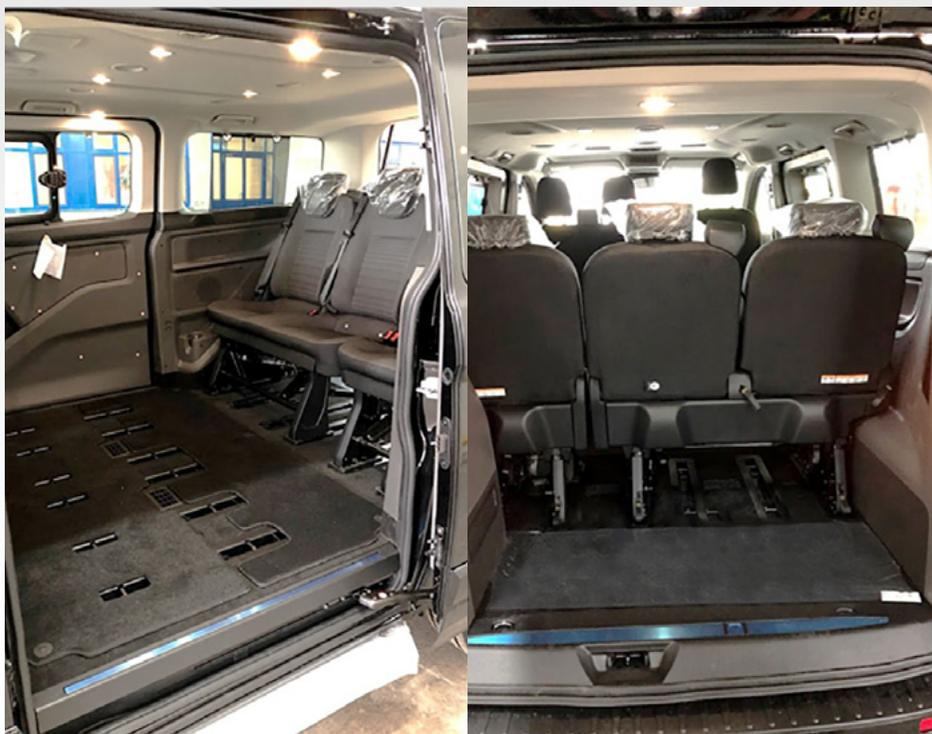
Ce pack retire les première et deuxième rangées de sièges simples standard et ajoute un siège double et un siège simple dans la troisième rangée. (Véhicule incomplet - Multi-étapes)
