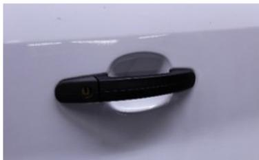
Le pack Sécurité poignée de claquage de TVL est conçu pour remplacer le verrou standard du véhicule et procurer une sécurité accrue.
