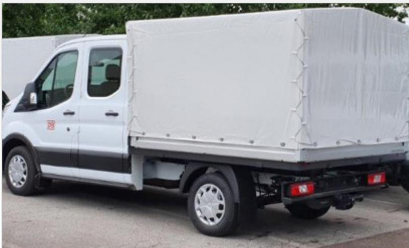
Cette option inclut le montage d'un kit Bâche sur un Transit Châssis-Cabine double La Bâche enserme tout l'espace de chargement. Des crochets et une corde permettent de l'ouvrir et de la fermer facilement.
