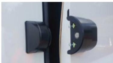
Le pack Sécurité ArmourShell de TVL est conçu pour remplacer le verrou standard du véhicule et procurer une sécurité accrue.
