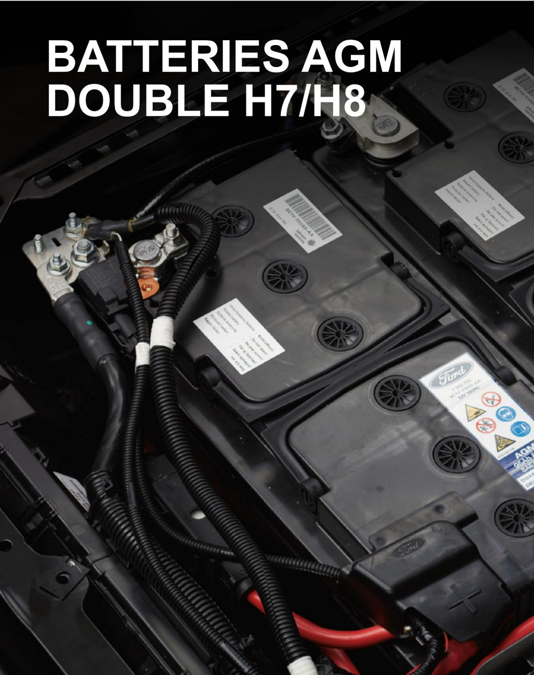
La technologie AGM (Absorbent Glass Mat) permet aux batteries double AGM H7/H8 d'alimenter les équipements auxiliaires nécessitant une alimentation électrique constante lorsque le véhicule est à l'arrêt, ou une alimentation à charge élevée de courte durée, en particulier lorsque le véhicule est au ralenti ou moteur éteint.
