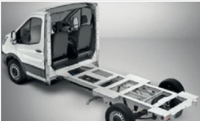
Cette nouvelle configuration de cabine permettra un accostage facilité des carrosseries, tout en permettant de conserver la possibilité de passage de la cabine à l'aménagement arrière.
