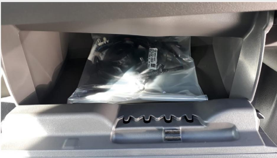
Cette option permet au client de commander l'avertisseur sonore et son faisceau de câbles démontés, livrés dans un sac plastique, pour châssis modulaire.
