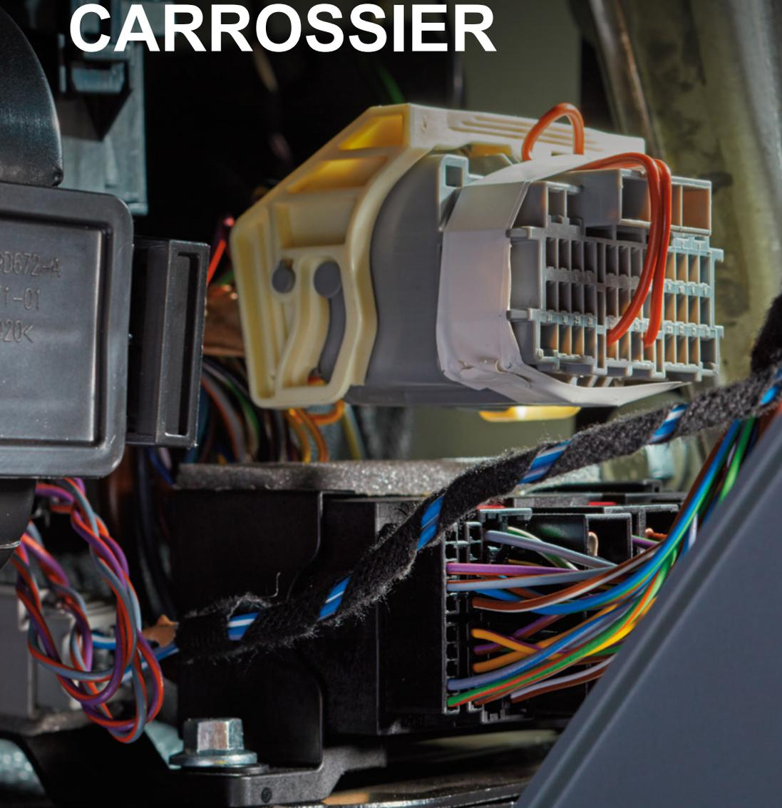
Le connecteur interface carrossier fournit une connectivité complète pour divers signaux électriques du véhicule. Le connecteur se trouve dans le tableau de bord, derrière la boîte à gants.
