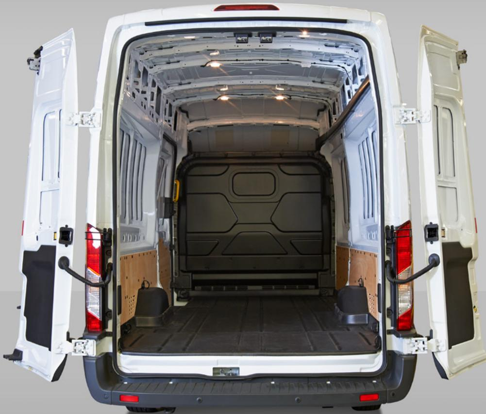
Cette option minimise la largeur totale du véhicule lorsque les portes arrière sont ouvertes, pour un accès supérieur aux zones de chargement. Grâce aux aimants de portes, celles-ci sont retenues contre le flanc extérieur du véhicule lorsqu'elles sont complètement ouvertes. Disponible sur Transit L2\*, L3, L4.
