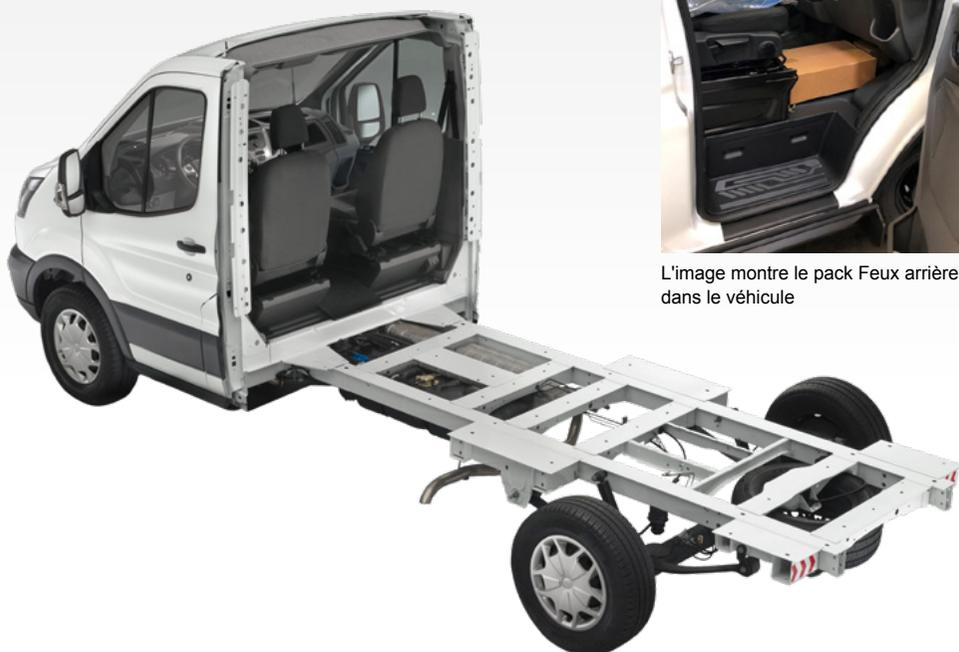
Le Transit Châssis Modulaire est actuellement fourni sans unités de feux arrière et sans lampes pour plaque d'immatriculation arrière. Ces véhicules sont livrés incomplets et il n'y a aucun emplacement pour monter les feux arrière (du fait de l'absence de pare-chocs). Pour installer les feux sur chaque véhicule, les carrossiers ont donc besoin d'un pack Feux arrière Transit Châssis Modulaire. Le pack sera fourni à l'intérieur du véhicule (voir image ci-dessous).
