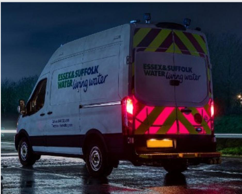
Une bonne visibilité est la pierre angulaire de la sécurité routière, en particulier si vous devez rester à l'arrêt à proximité de voies de circulation. Encore plus efficaces que les bandes réfléchissantes et lumineuses, les panneaux électroniques haute visibilité sont une nouvelle technologie qui éclaire la partie rouge des panneaux, ce qui permet aux autres usagers de la route de voir plus facilement le véhicule même s'ils ne sont pas directement derrière lui.
