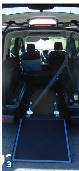
**1** La version HANDI AIR est équipée d'une suspension pneumatique permettant l'abaissement arrière du véhicule, une rampe d'accès courte et un confort de la personne en fauteuil
