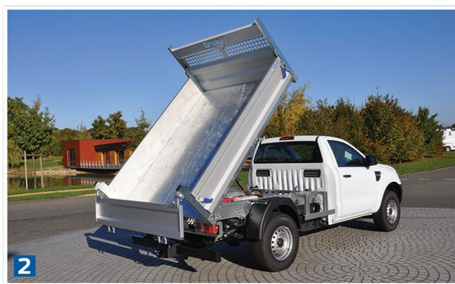
**2** Plateau en acier galvanisé à chaud pour une meilleure tenue à la corrosion
