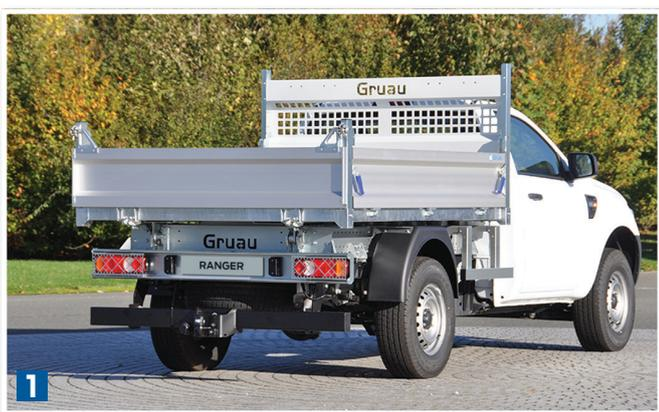
**1** Ridelles en aluminium pour plus de légèreté (gain de charge utile et facilité de manipulation), tout aussi résistantes que des ridelles acier, et insensibles à la corrosion
