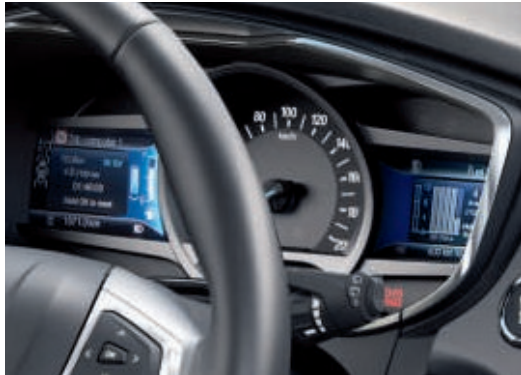
Combiné d'instrumentation couleur 2x4,2" avec Intelligent SmartGauge®
