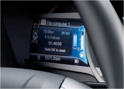
Combiné d'instrumentation couleur 2x4,2" avec Intelligent SmartGauge®
